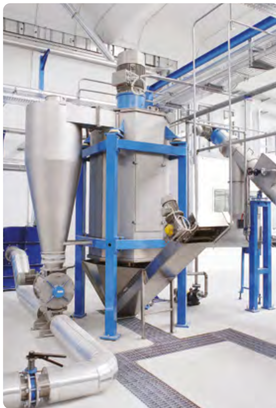
Centrifuga verticale per produzione fino a 4000 Kg/h Vertical centrifuge for production up to 4000 kg/h
