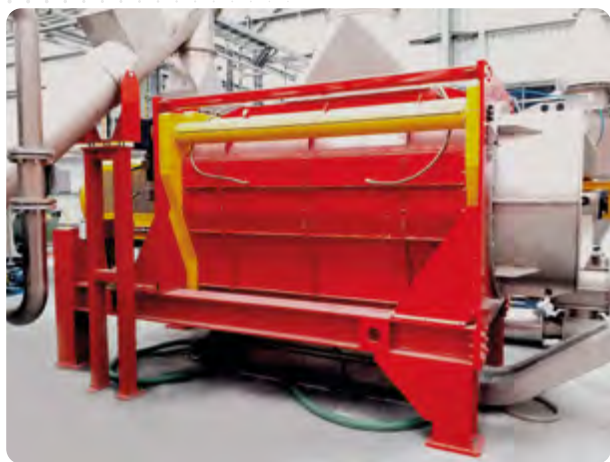
Centrifuga orizzontale per produzione fino a 6000 Kg/h Horizontal centrifuge for production up to 6000 Kg/h
