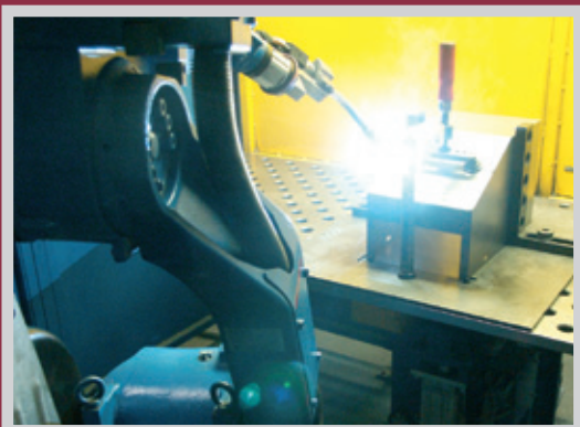
Laserbearbeitung von Ansauggehäusen / laser machining suction silencer
