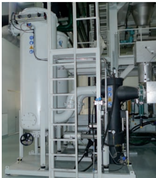
Polyestervorabscheidung mit automatischer Umschaltung für eine kontinuierliche Produktion Polyester pre separation with automatic change over for continuous operation
