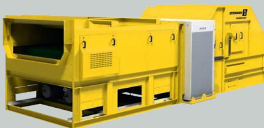
Das Röntgensortiersystem STEINERT XSS® T wird für die trockene Dichtesortierung eingesetzt. In einem transmittierenden Verfahren werden materialabhängige Unterschiede in der Absorption von Röntgenstrahlung detektiert, klassifiziert und zur Sortierung in Dichteklassen genutzt. In dem sogenannten Dual-Energy-Verfahren wird softwaregestützt die materialspezifische Absorption ermittelt und damit auf die Dichte des Materials geschlossen.
