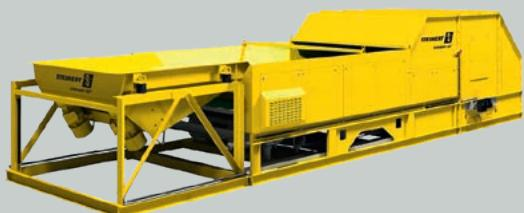
Es kann vorkommen, dass metallische Bestandteile nicht mit Hilfe von Magnetscheidern zur Eisen- und Nicht-Eisen Separation abgetrennt werden können (z.B. Edelstähle und Verbundwerkstoffe). In solchen Fällen ist das Sortiersystem STEINERT ISS die logische Ergänzung.
