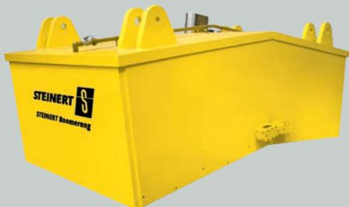
Der STEINERT Boomerang (Nettogewicht: 43 t) ist konzipiert für die Separation von störendem Fremdeisen und Grobteilen, wie Stangen und Baggerzähnen aus Erzen oder Kohle mit großen Massenströmen. Er wird dafür in den Abwurf einer Fördergurttrommel gehängt. Dort folgt er mit seiner charakteristischen Form ideal der Abwurfparrabel des Materialstroms.
