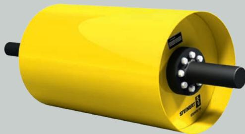
Magnetbandrollen von STEINERT gewinnen kleinere magnetisierbare Eisenteile aus Schüttgütern dort, wo sonst eine normale Umlenktrumme in die Bandförderanlage integriert ist. Magnetbandrollen schützen weitere Verarbeitungsanlagen vor Verschleiß und Zerstörung und gewinnen Feineisen zurück. Ausführungen mit starkem Neodym-Permanentmagneten holen gezielt schwach magnetische und besonders kleinstückige Bestandteile aus dem Fördergut.
