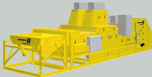
Das Kombinationssortiersystem STEINERT KSS | XF L vereint die XRF-Sensorik mit einer 3D-Erkennung. Mittels Lasertriangulation findet eine präzise Objekterfassung statt, die eine eindeutige Zuordnung aller detektierten Signale ermöglicht.
