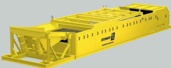
Der STEINERT SteelMaster nutzt eine Kombination aus ballistischen und magnetischen Effekten zur Trennung von kupferhaltigen Verbunden, den sogenannten Meat-balls, aus einer schweren Eisen-Fraktion. Mit dieser Sortiermaschine werden Kupferspulen mit Eisenkern (Kupferanker bzw. Meatballs) in einem Stoffstrom angereichert.
