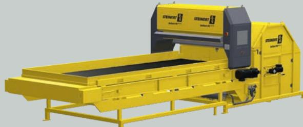
Die fünfte UniSort PR Gerätegeneration bietet neben umfangreichen Hardwareverbesserungen zur vereinfachten Wartung die Basis für die Künstliche Intelligenz-gestützte Objekterkennung Intelligent Object Identifier. Dies ermöglicht die Lösung komplexer Sortieraufgaben und macht diese neue Gerätegeneration flexibel einsetzbar (z.B. zur Erkennung und Sortierung von Silikonkartuschen aus PE-Produkten, oder PET Flaschen von PET Schalen).
