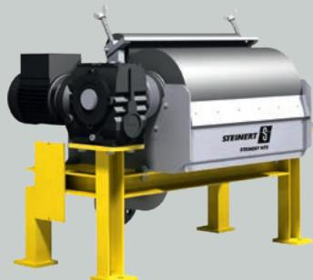
Für den feinstkörnigen Bereich ( $<10\text{ }\mu\text{m}$ ) wurde der STEINERT NTS (Nasstrommelscheider) entwickelt. Er konzentriert das Spülkonzentrat des STEINERT HGF zu einem hochangereicherten Schlamm. Auch reinigt er bei kleineren Durchsätzen mühelos Entfettungsbäder und andere Flüssigkeiten. Sein besonders starkes Neodym-Magnetsystem sorgt auch in dieser Korngröße für eine zuverlässige Erfassung.
