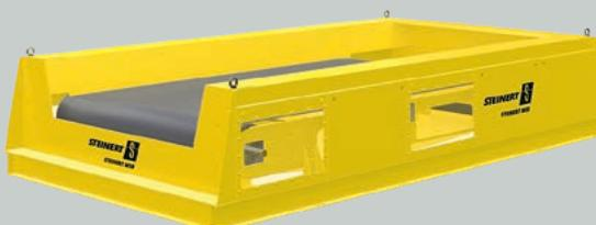
Der Magnetbandrollenscheider STEINERT MSB besteht aus einem Förderband mit magnetischer Bandrolle des Typs STEINERT BR. Diese ist passend zum Einsatzfall mit Permanentmagneten oder elektromagnetischen Spulen bestückt. Bei gleichbleibendem Magnetfeld am Kopf der Trommel wird das Sortierergebnis hauptsächlich über die Geschwindigkeit des umlaufenden, frequenzgeregelten Fördergurtes und die Position des oder der Trennscheitel gesteuert.
