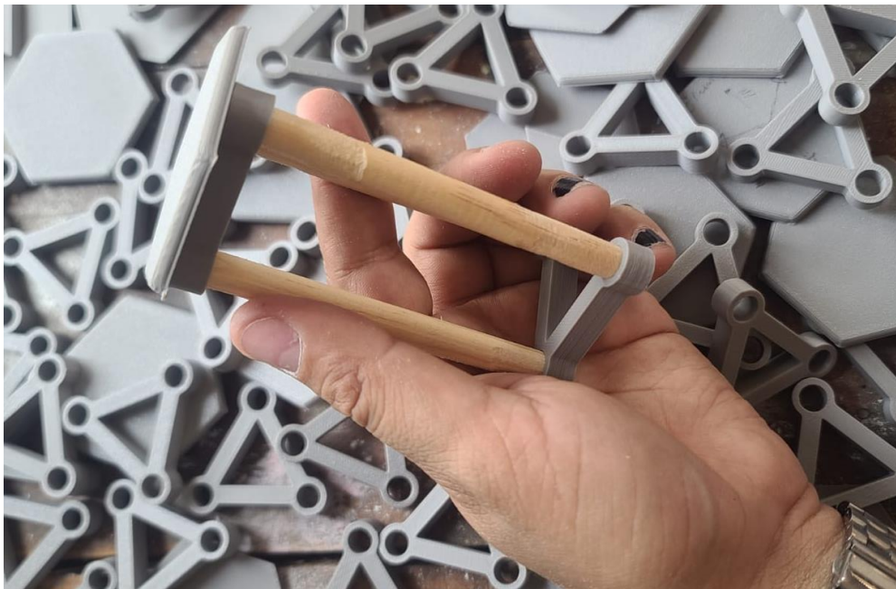
Figura 26: Fotografía de las piezas impresas en 3D que conforman la estructura interna del contenedor, Elaboración propia, 2025
