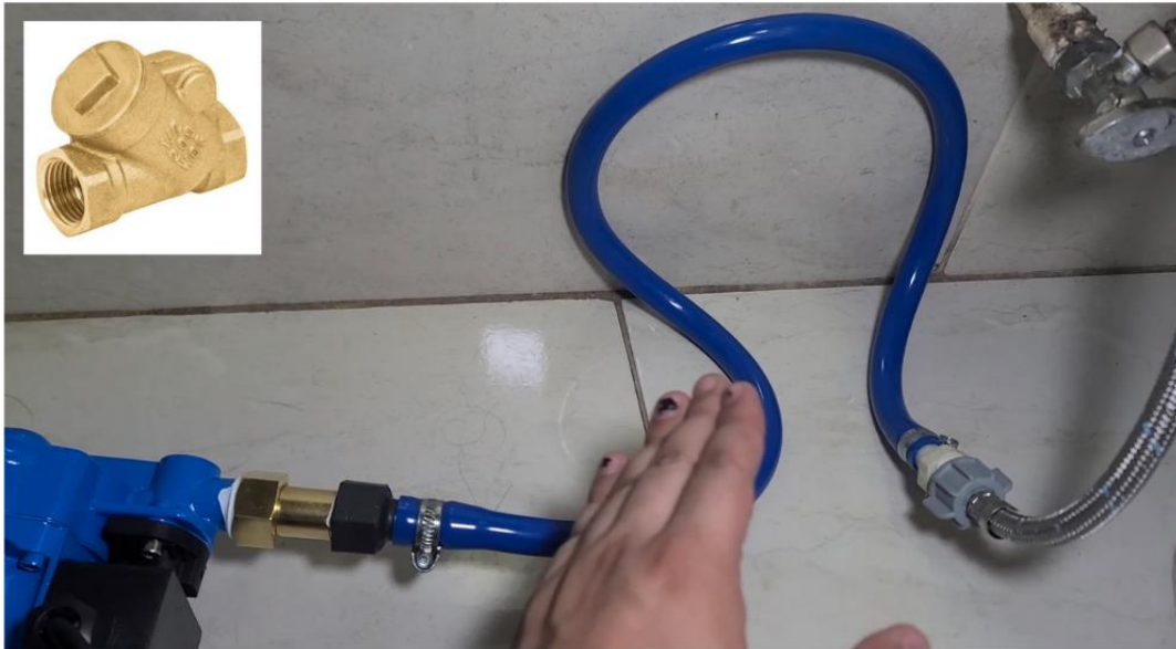
Figura 30: Captura de la conexión posterior a la bomba presurizadora del video de la validación del funcionamiento del sistema SIS-MAAR V1.0, Elaboración propia, 2025
